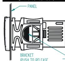
XR70CX 温控器应该固定在竖直的面板上,面板上开孔尺寸 29x71 mm,并用专用的塑料卡子将其固定。
