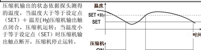
注: 一旦温度探头失灵 (未可靠连接或损坏) 压缩机按照参数 "COn" 和 "COF" 所设定的运转时间和停止时间以固定开停比的方式来运行。
