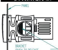
XR64CX 温控器应该固定在竖直的面板上, 面板上开孔尺寸 29x71 mm, 并用专用的塑料卡子将其固定。工作环境需在 0-60 °C 范围内才能保证其正常运行, 应避免放置在有较强震动、有腐蚀性气体、脏乱不堪及潮湿的地方。探头的安装也有同样的要求。让空气能够从温控器的散热孔流通起来, 以便带走热量。
