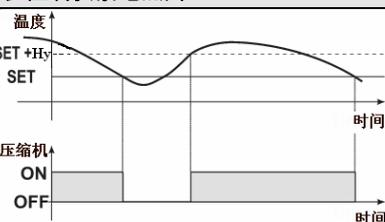
注: 一旦温度探头失灵(未可靠连接或损坏)压缩机按照参数“CO<sub>n</sub>”和“CO<sub>F</sub>”所设定的运转时间和停止时间以固定开停比的方式来运行。
