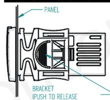
XR40CX 温控器应该固定在竖直的面板上, 面板上开孔尺寸 29x71 mm, 并用专用的塑料卡子将其固定。工作环境需在 0~60 °C 范围内才能保证其正常运行, 应避免放置在有较强震动、有腐蚀性气体、脏乱不堪及潮湿的地方。探头的安装也有同样的要求。让空气能够从温控器的散热孔流通起来, 以便带走热量。
