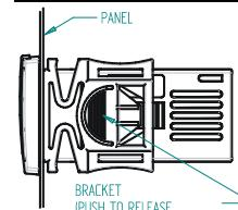
XR30CX 温控器应该固定在竖直的面板上, 面板上开孔尺寸 29x71 mm, 并用专用的塑料卡子将其固定。
